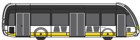
Inverkehrsetzung: 2021 – 2022, Länge: 12,165 m, Reichweite: 80 km, Batteriespeicher: 90 kWh, Ladeleistung: 450 kW, Leistung: 180 kW, Drehmoment: 3000 Nm, Höchstgeschwindigkeit: 85 km/h, Anzahl Sitz- und Stehplätze: 80
